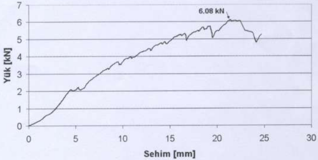
Şekil 8: 3 no'lu numune için eğilme direnci ve yük-sehim eğrisi grafiği.
