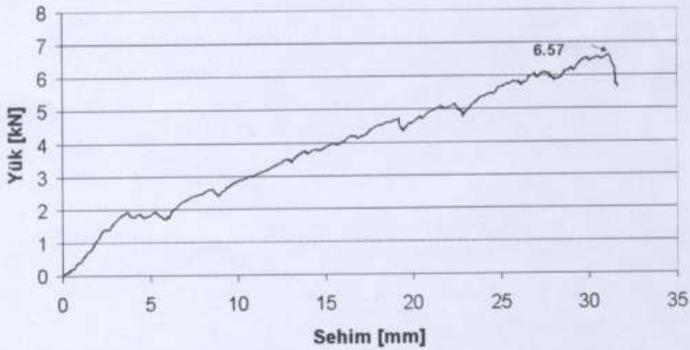
Şekil 7: 2 no'lu numune için eğilme direnci ve yük-sehim eğrisi grafiği.
