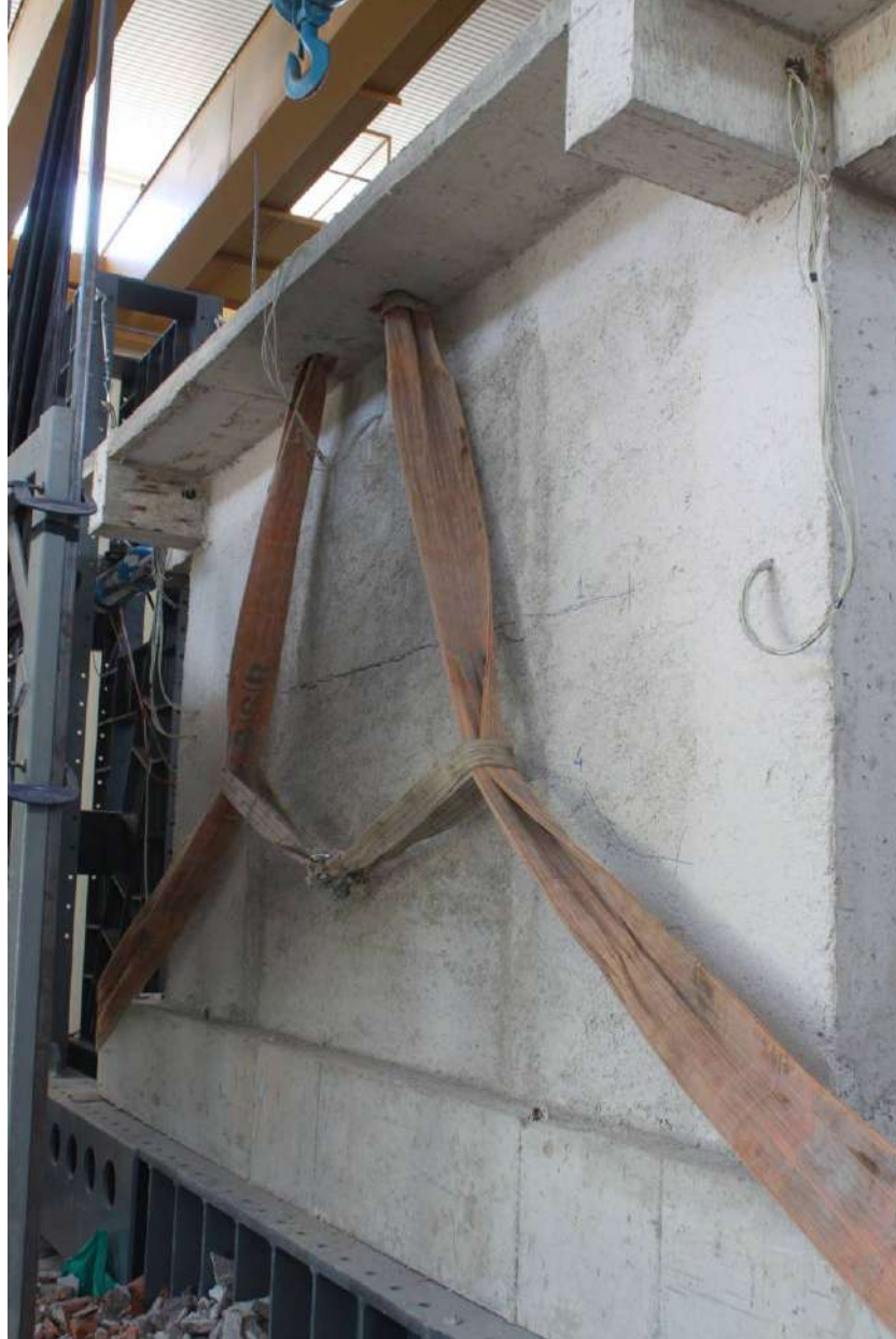
Şekil 6.13. Düzlemdışı yüklemeler sırasında duvar arkasında gerçekleşen yatay açılmalar.
