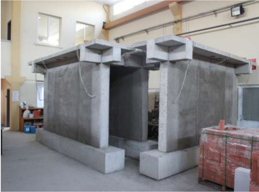
Şekil 4.9. Duvar örümü ve sıva işleri tamamlanan N2, N3 ve N4 numuneleri
