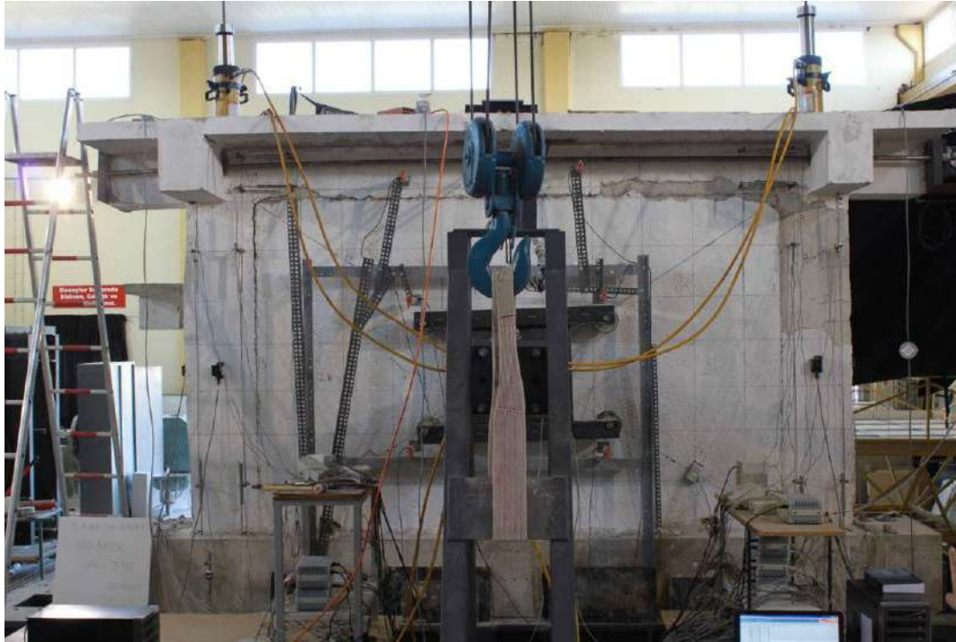
(b) Çerçeve ve duvar etkileşimi sonucu gelişen ilerlemiş ara yüz hasarları.
