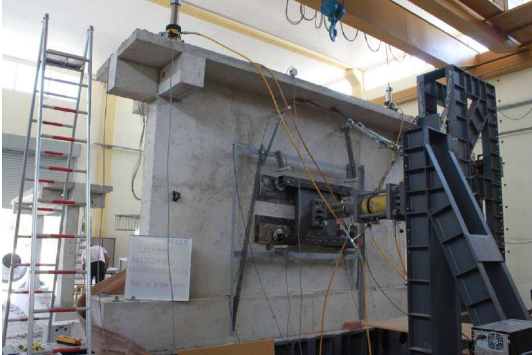
Şekil 6.10. Düzlemdışı test sisteminin genel görünümü.
