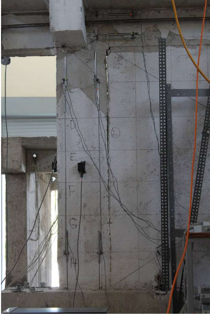
(b) Çerçeve ve duvar etkileşimi sonucu gelişen ilerlemiş ara yüz ve birleşim hasarları – çekme çevriminden bir görüntü.
