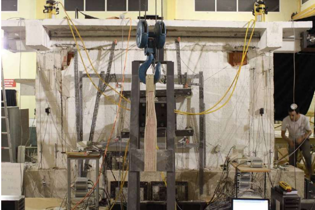
(d) İlerlemiş duvar köşe hasarları ve duvarda gelişen diyagonal çatlaklar.
