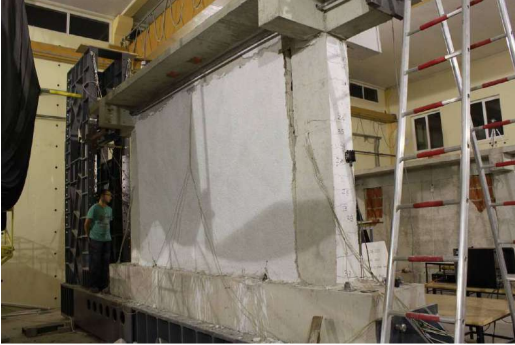
(d) Deneyin ilerleyen aşamalarında düzlem dışına doğru daha çok hareket eden duvar.
