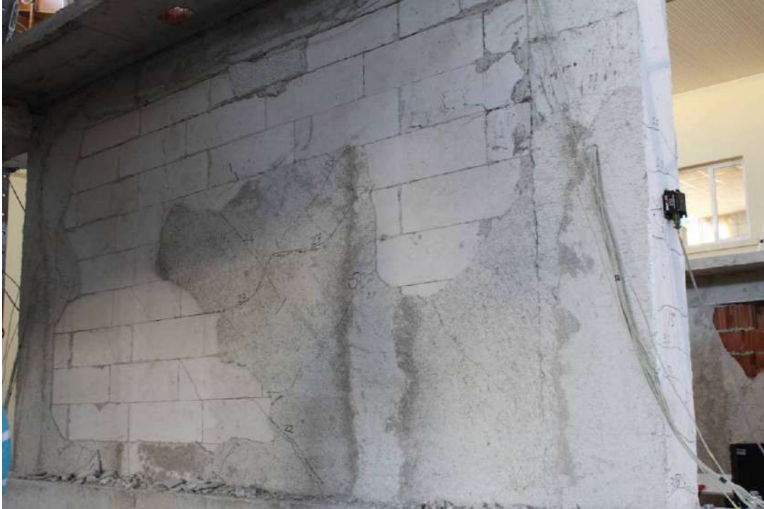
(f) Duvarın arka yüzünde gelişmiş olan gaz beton birimlerinde görülen yaygın hasar ağı.
