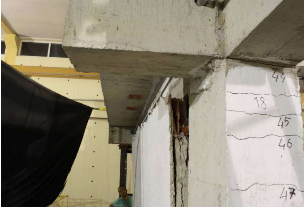
(e) Duvarın deney sonunda ulaşılan düzlem dışı hareketi.
