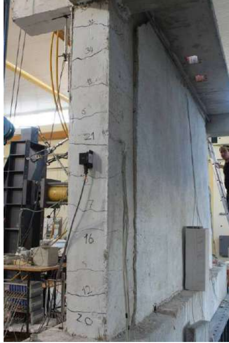
(b) Düzlem dışına doğru hareketlenmiş duvarın görünümü (çerçevenin arkası).
