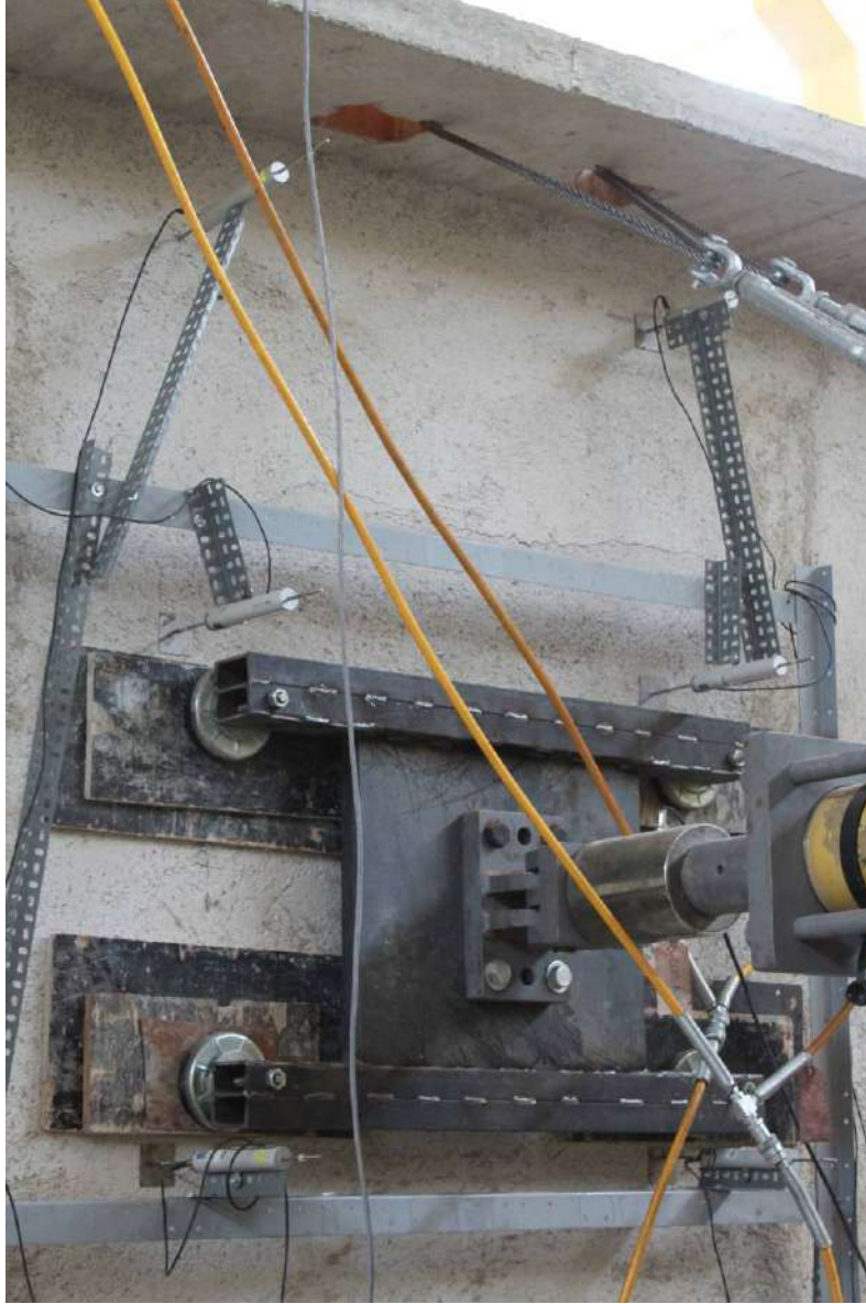
Şekil 6.12. Duvarın çerçeveye göre düzlemdışı hareketlerinin izlenmesi.
