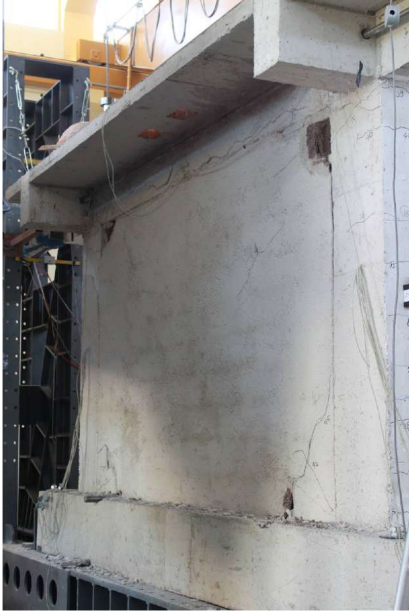
(c) Duvarın üst köşelerinde gelişen hasarlar, topuk hasarları ve duvar gövdesinde gelişen diyagonal çatlaklar.
