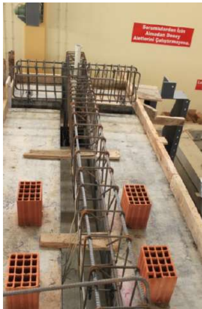
Şekil 4.4. Kolon ve kiriş elemanların donatılarına yerleştirilen gerinim ölçerler.
