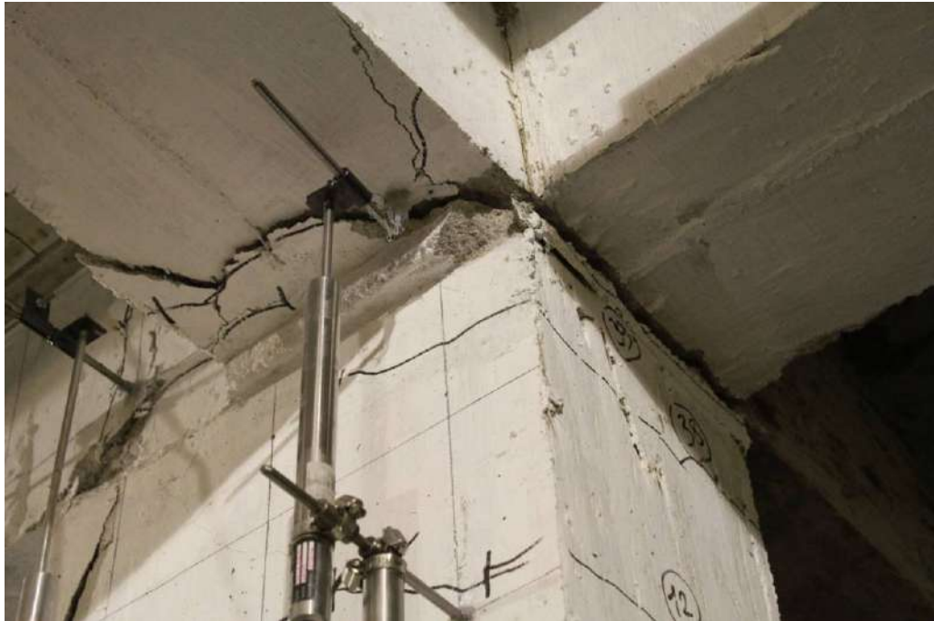
(g) Kolon-birleşim arayüzünde eğilme etkileri sonucu açılma.
