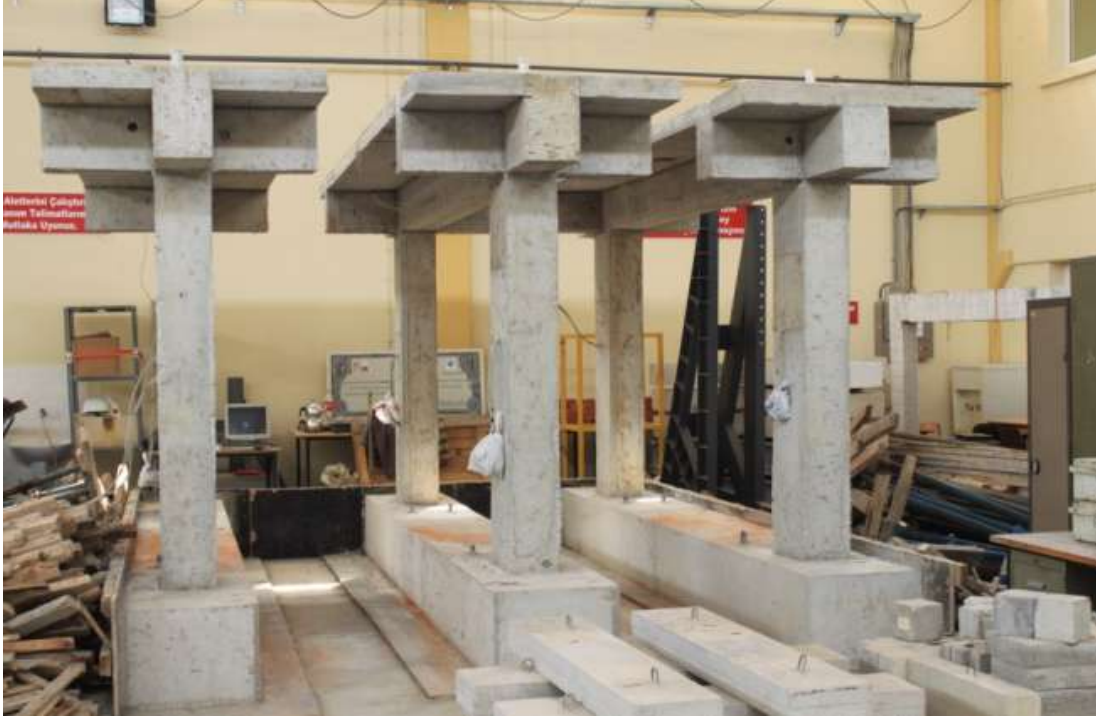
Şekil 4.6. Kalıptan alınan betonarme çerçeveler.
