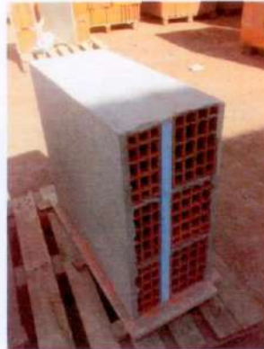
Sandviç Tuğla Duvar (Çift taraflı sıvalı) (13,5 cm. Y.D.Tuğla+ 3 cm. XPS+ 8,5 cm. Y.D.Tuğla)
